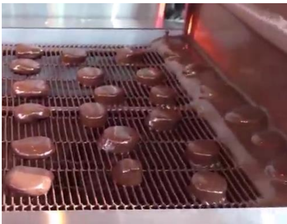
Рисунок 2.4 – Попадання виробу з сітки глазурування на сітковий конвеєр
