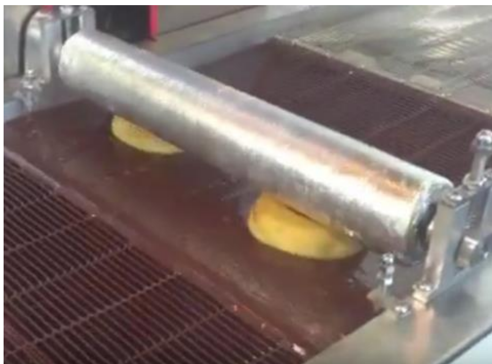
Рисунок 2.6 – Виріб під верхнім валом при односторонньому глазуруванні на сітці глазурування
