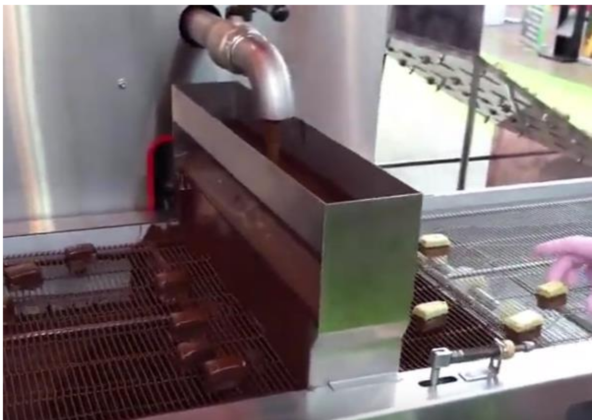
Рисунок 2.2 – Вкладання виробів на сітку глазурування
