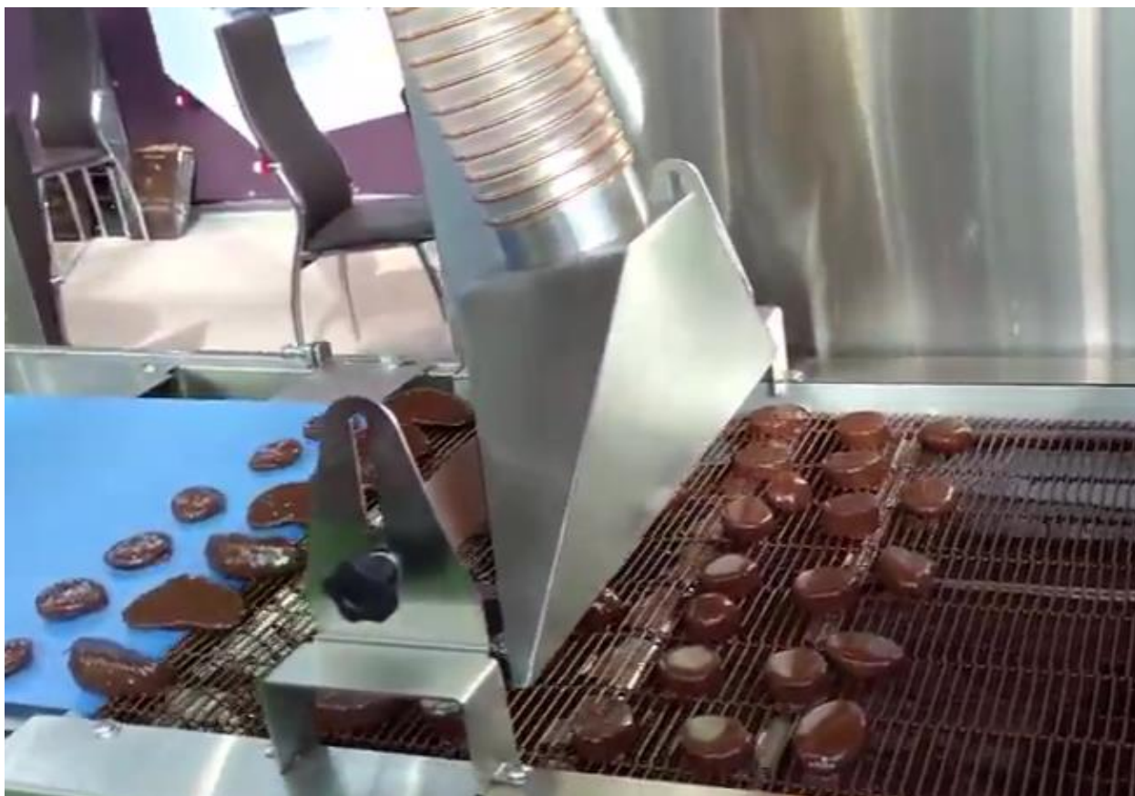
Рисунок 2.5 – Обдування виробу та попадання його на ленточний конвеєр
