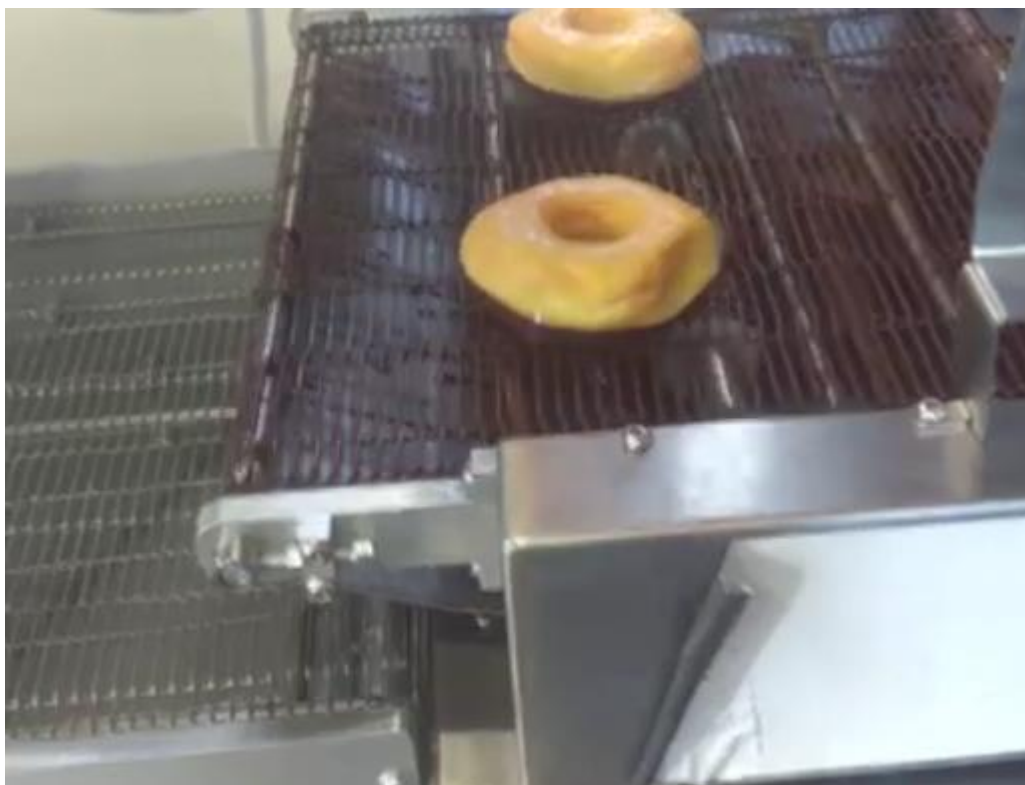
Рисунок 2.7 – Транспортування від сіткового конвеєру до поворотного конвейєру
