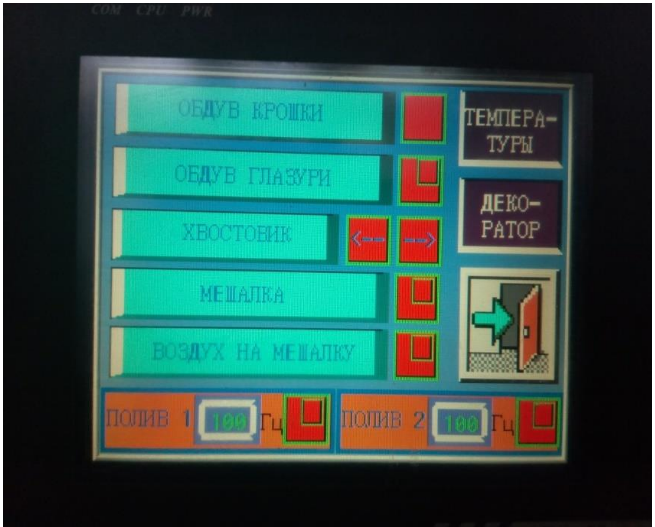
Рисунок 3.7 – Налаштування параметрів глазурування
