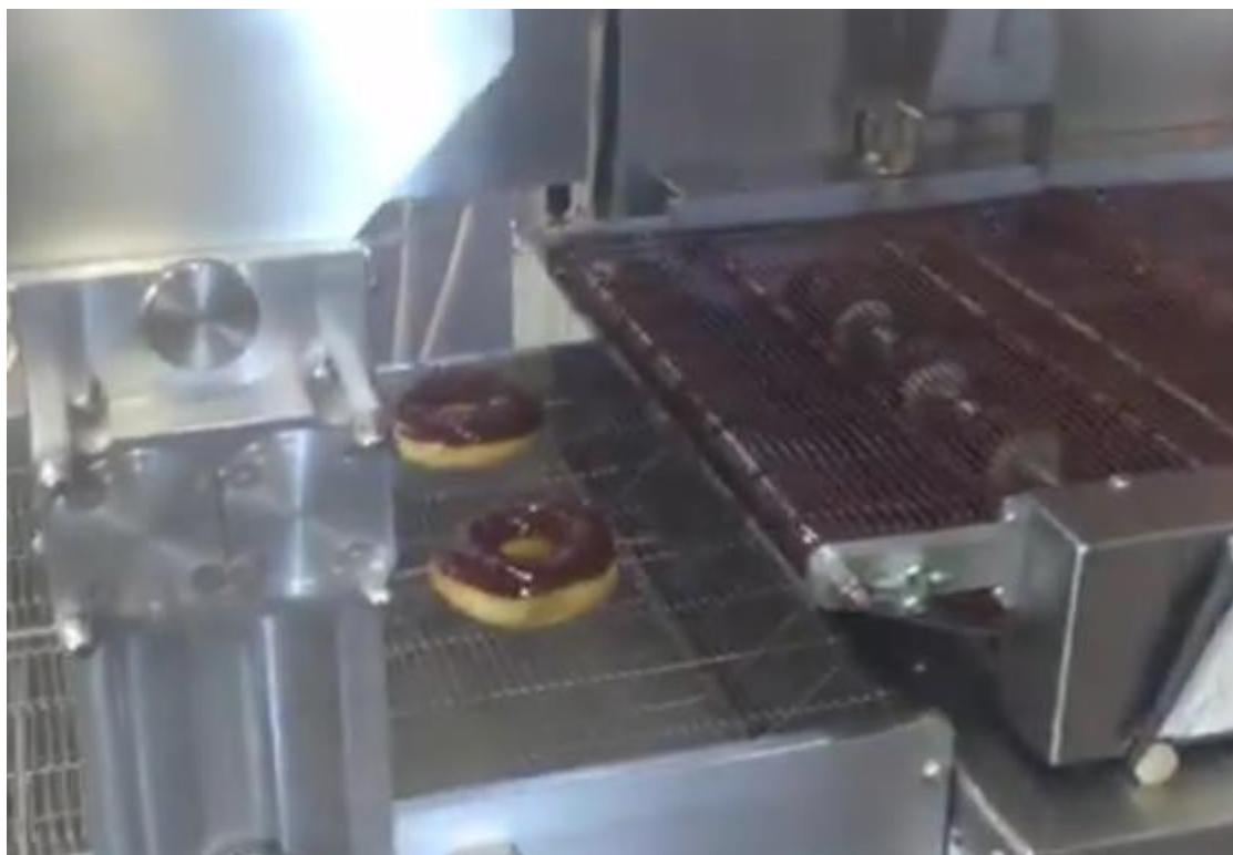
Рисунок 2.8 – Попадання виробу на поворотній конвеєр
