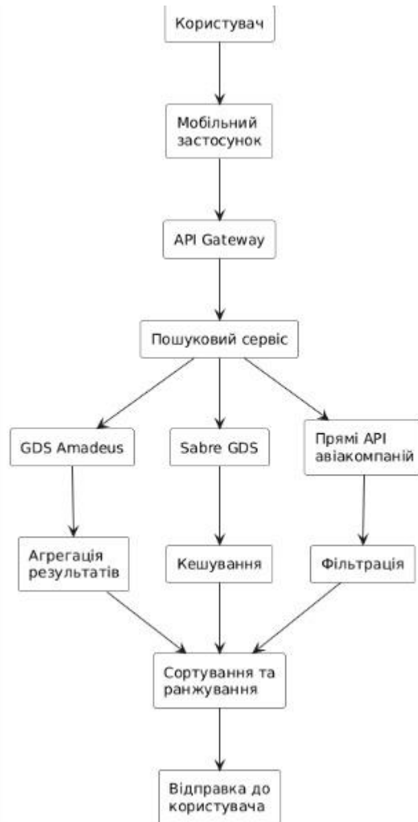
Рисунок 1.2 - Діаграма взаємодії компонентів при пошуку рейсів [8]
