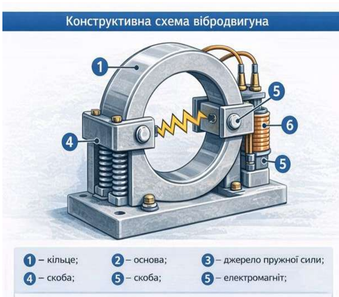
1 – кільце; 2 – основа; 3 – джерело пружної сили; 4 – скоба; 5 – електромагніт; 6 – якір
