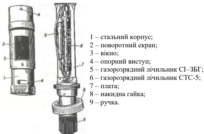
Рисунок 5.2 – Зонд зі знятим корпусом
