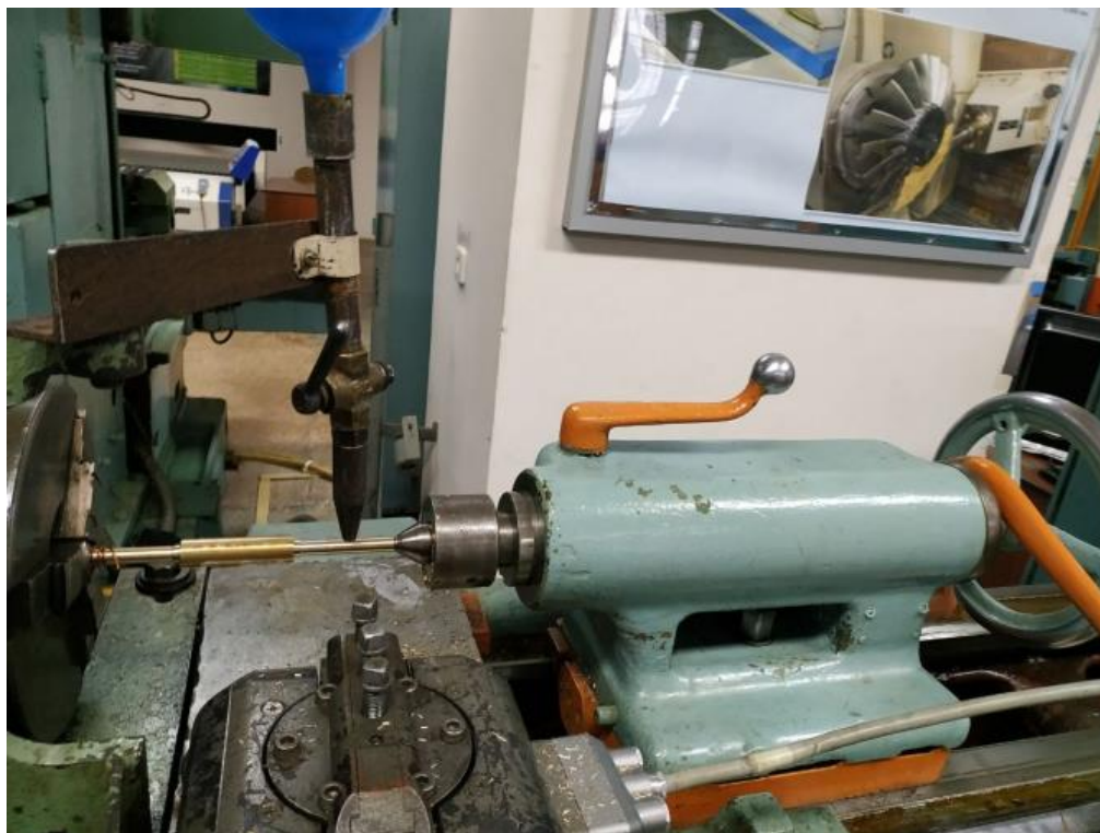
Рисунок 6.2- Проведення динамічних дослідів на заготовці БрО5Ц5С5
