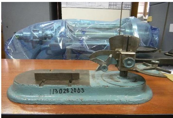
Рисунок 3.10 - Настільний кутомір для контролю кутів заточки токарного різця
