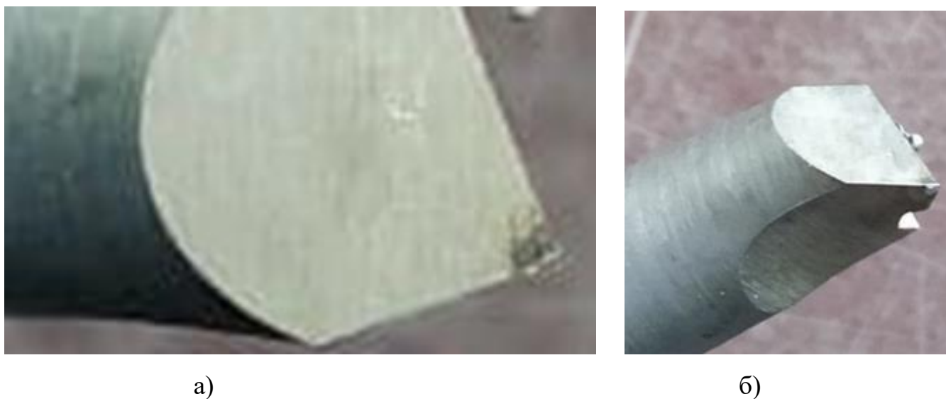
Рисунок 6.16 – Різець №2 після операції різання з використанням Ацетону
