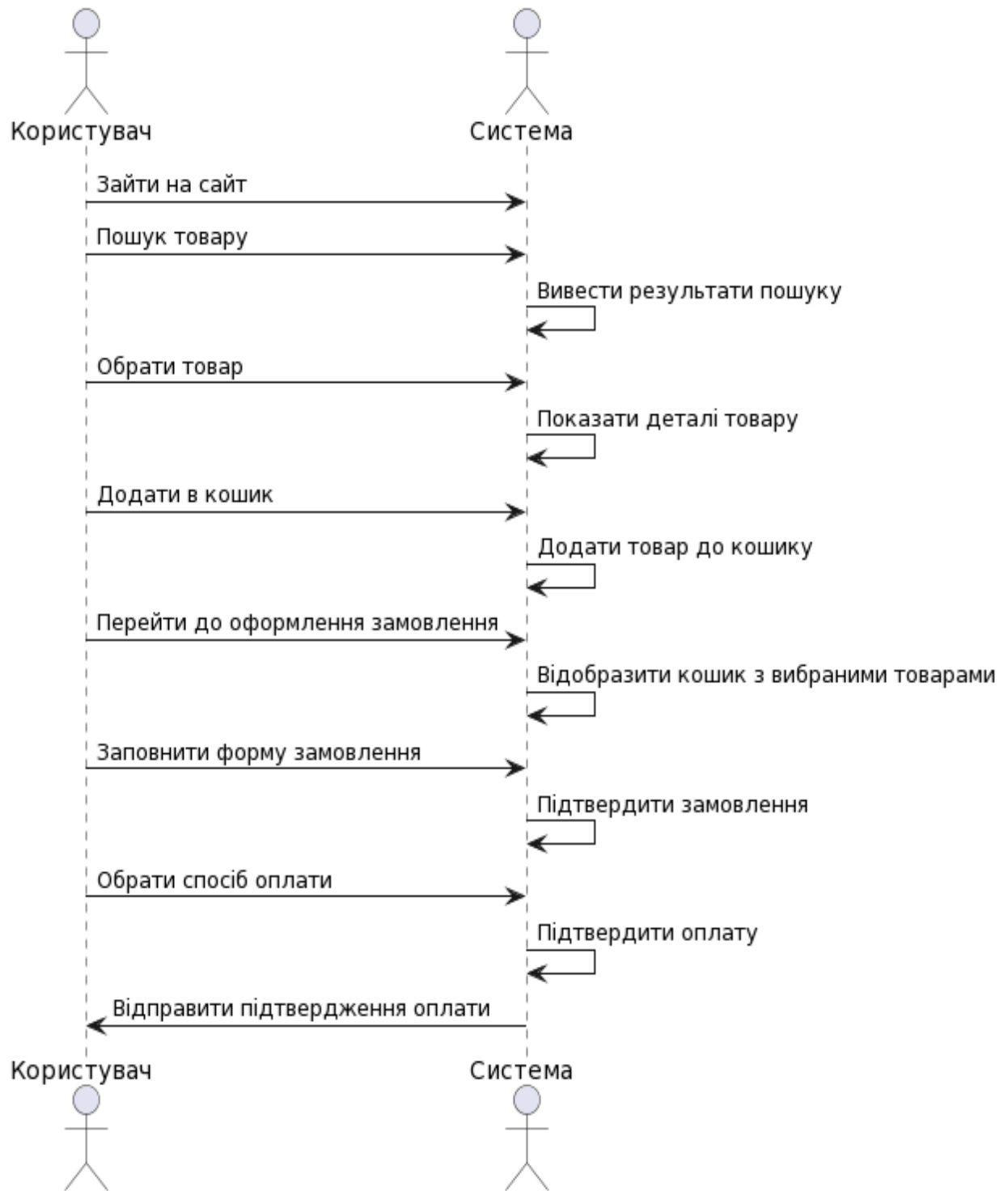
Рисунок 3.6 - Діаграма взаємодії користувача з програмним забезпеченням вебсайту інтернет-магазину будівельних матеріалів у нотації UML
