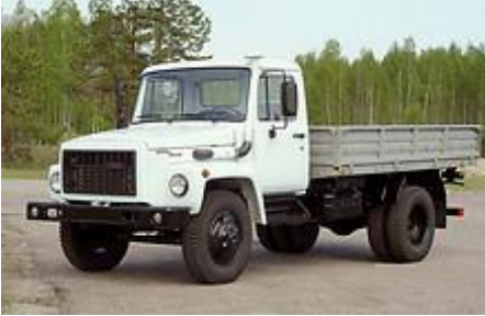
Рисунок Г.6 - Вантажний ГАЗ-3309 з двигуном Д-245.7 (EURO-2)
