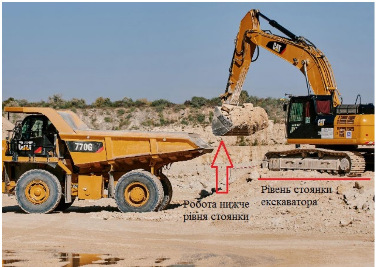
Рисунок 1.4 – Використання екскаваторів із зворотною лопатою для навантаження вапняку у самоскиди
