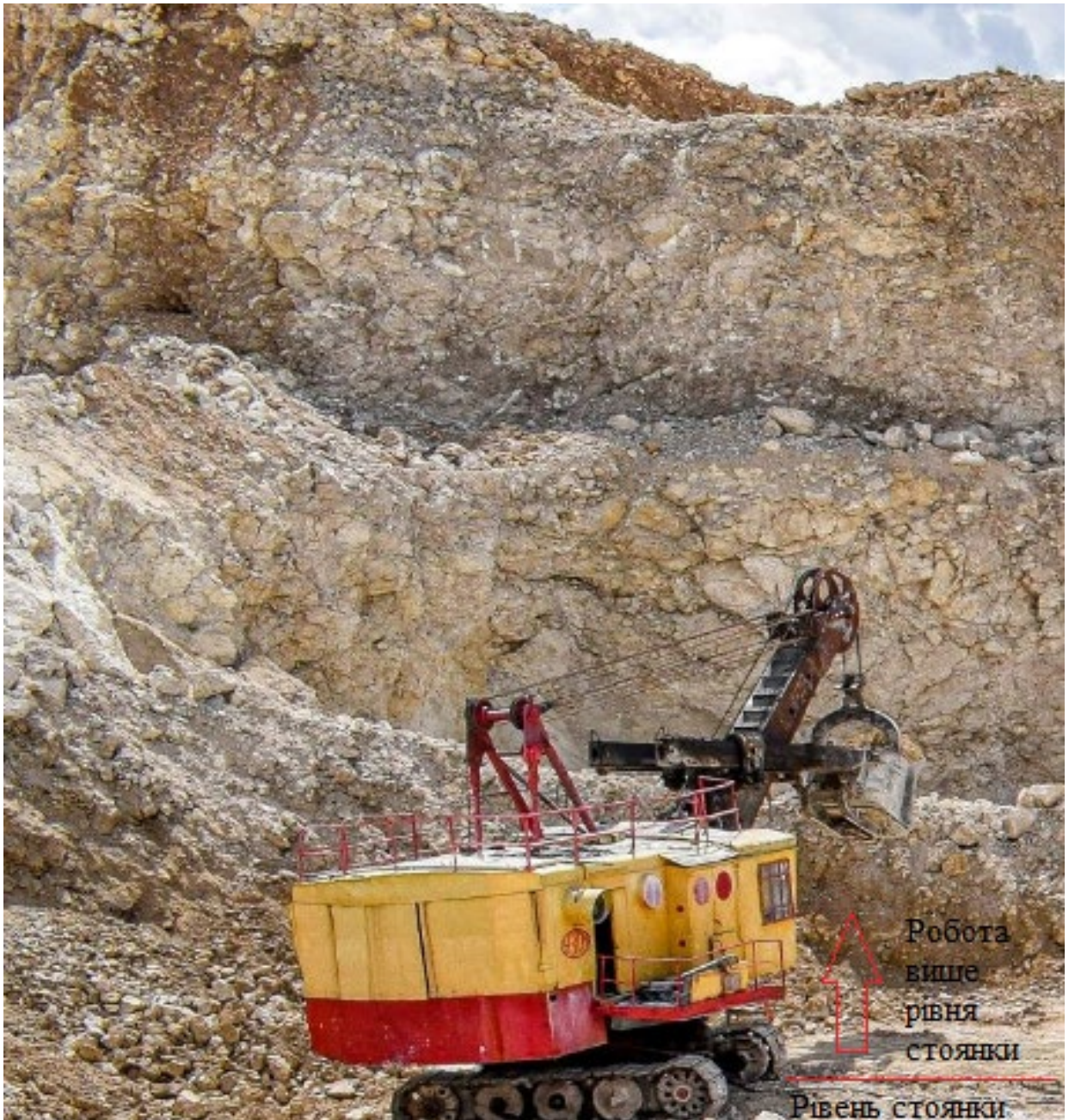
Рисунок 1.2 – Видобуток вапняку кар’єрним екскаватором з прямою лопатою
