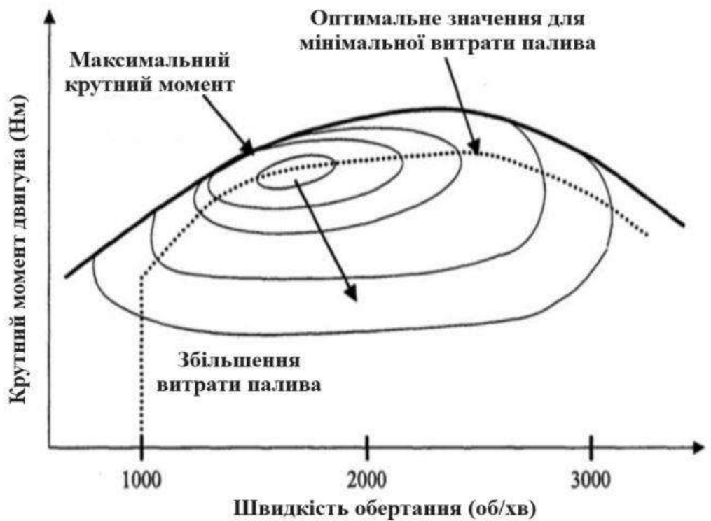
Рисунок 3.3 – Характеристики дизельного двигуна, що пов'язані з двохолюсним генератором
