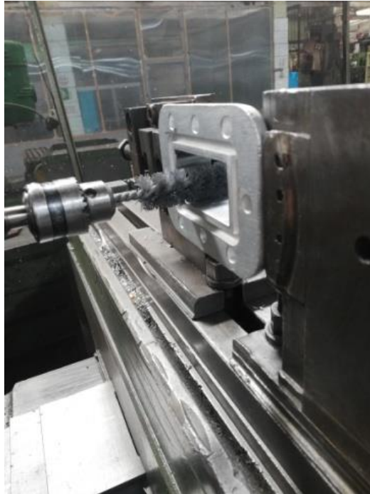
Рисунок 5.3 – Обробки щітковими інструментами хвилеводу на верстаті з ЧПК
