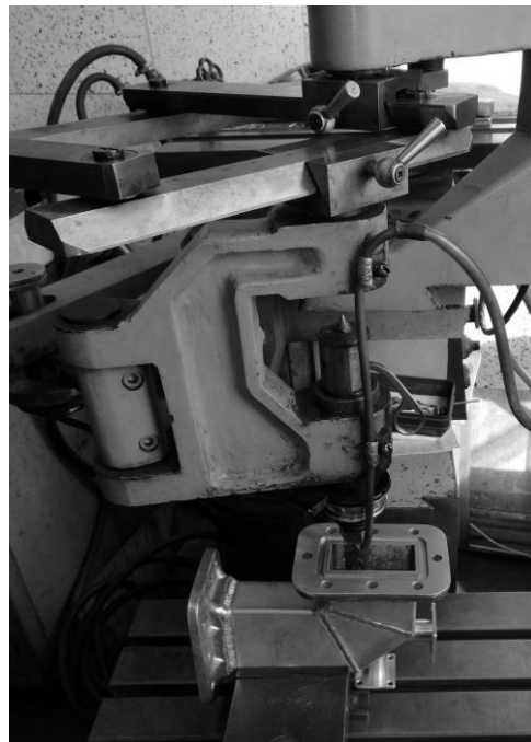
Рисунок 5.4 – Обробки щітковим інструментом хвилеводу на спеціальній установці
