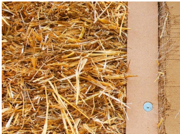
Рисунок 1.9 – Теплоізоляційний матеріал з солом'яних тюків
