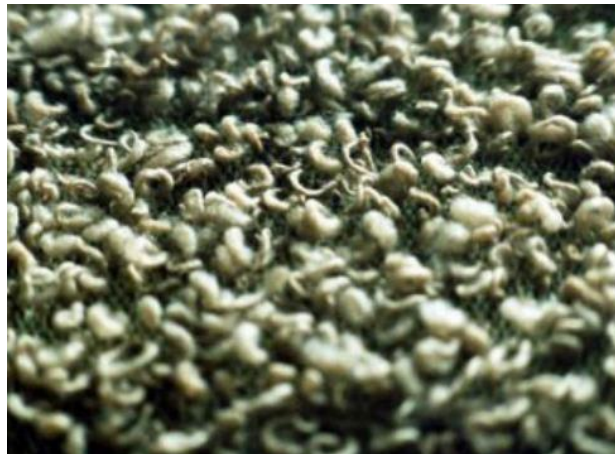
Рисунок 1.6 – Теплоізоляційний матеріал з пластикових волокон
