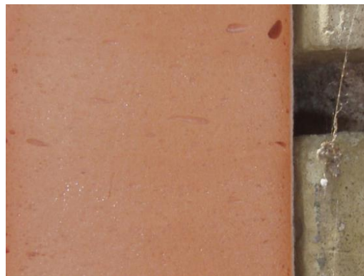
Рисунок 1.16 – Теплоізоляційний матеріал з фенолформальдегідної піни
