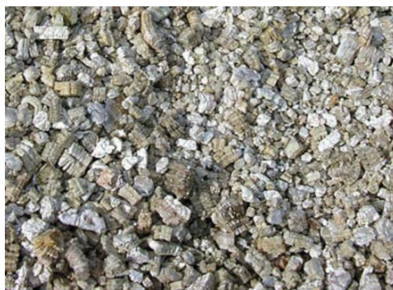
Рисунок 1.13 – Теплоізоляційний матеріал з вермікуліту
