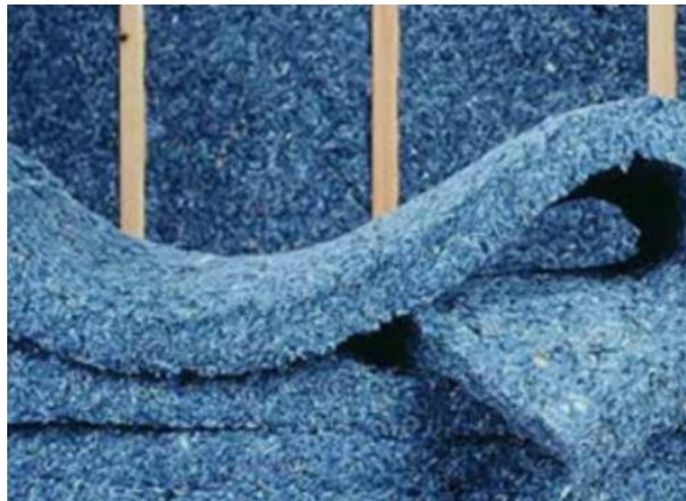
Рисунок 1.7 – Теплоізоляційний матеріал з бавовняної вати
