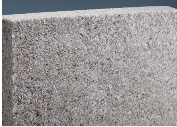
Рисунок 1.6 – Теплоізоляційний матеріал целюлозна ізоляція
