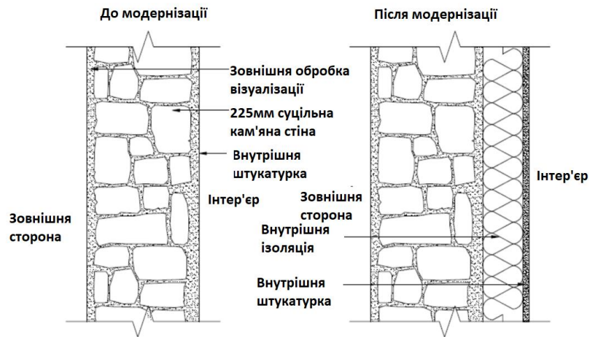
Рисунок 1.24 - Ілюстрований переріз зовнішньої стіни будівлі №2 випадку, до модернізації та після модернізації.
