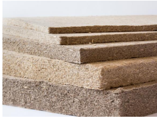
Рисунок 1.10 – Теплоізоляційний матеріал з конопляних рослин
