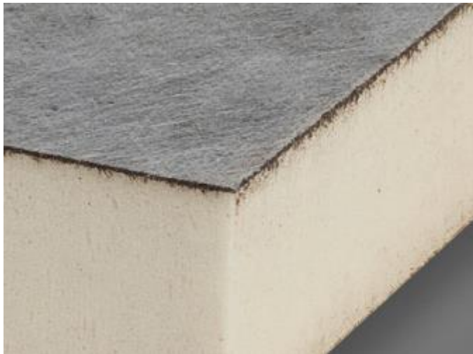
Рисунок 1.12 – Теплоізоляційний матеріал з поліізоціанурату
