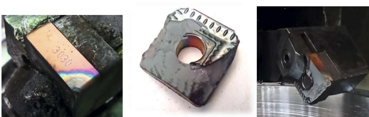
Рисунок 1.1 – Зношування та поломка інструменту
