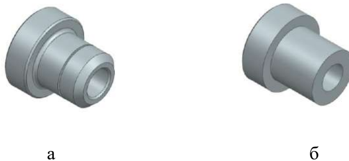
Рисунок 2.10 – 3D модель деталі після обробки (а) та до обробки (б)
