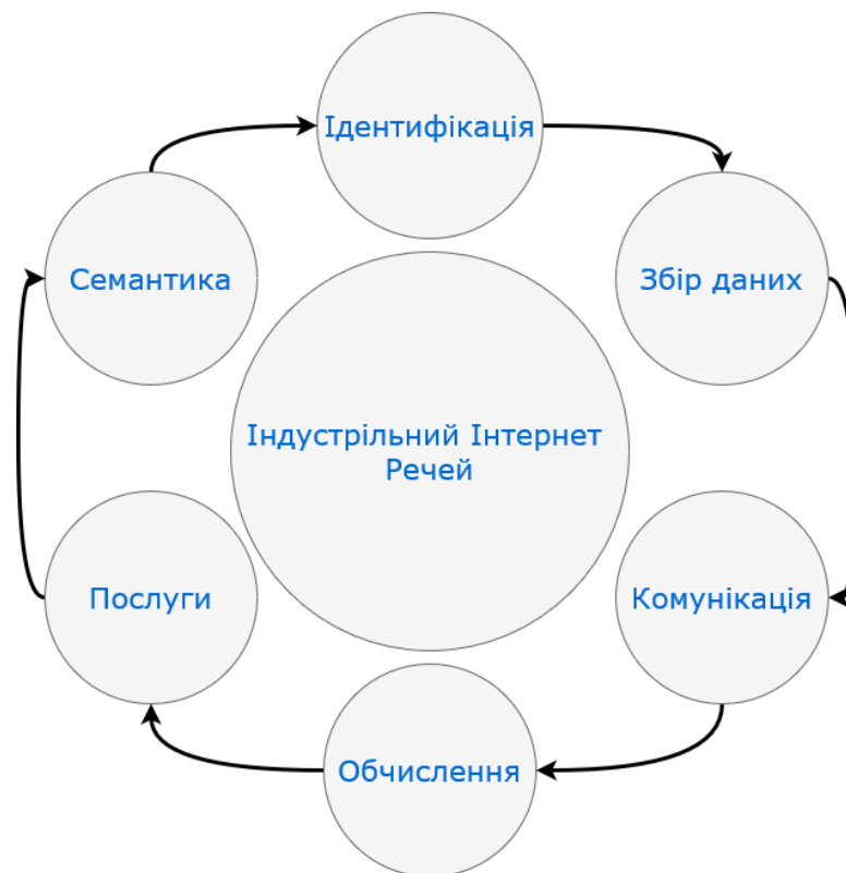
Рисунок 1.2 – Схема роботи Інтернету речей на промисловому виробництві [11]
