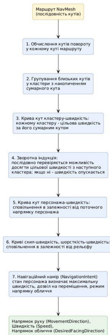
Рисунок 3.21 – Алгоритм планування швидкості навігаційним контролером
