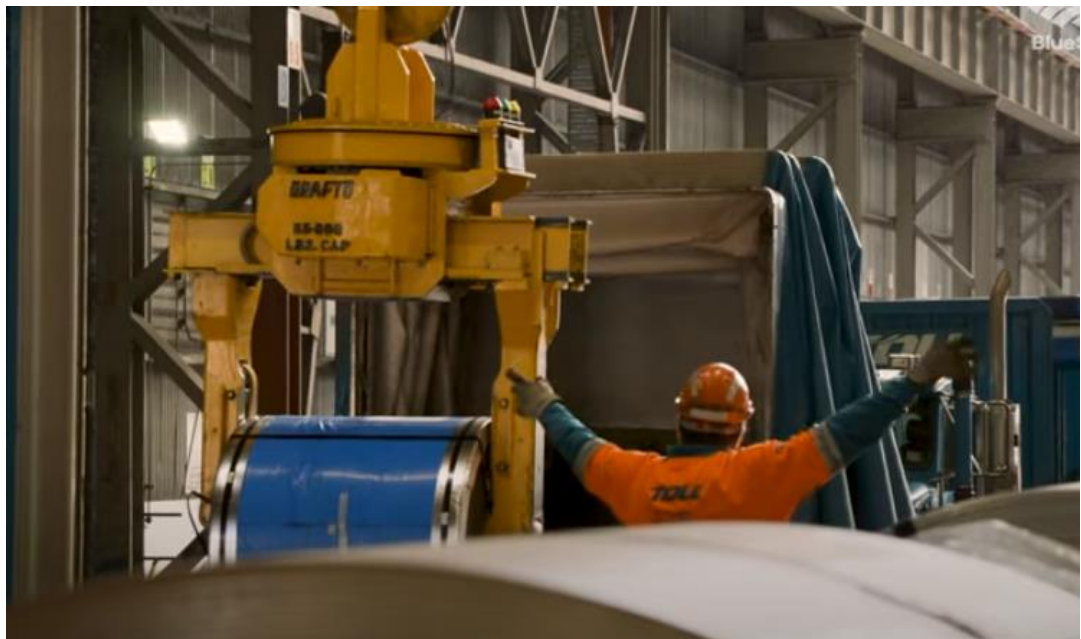
Рисунок 1.16 – Процес навантаження рулонів на автотранспорт
