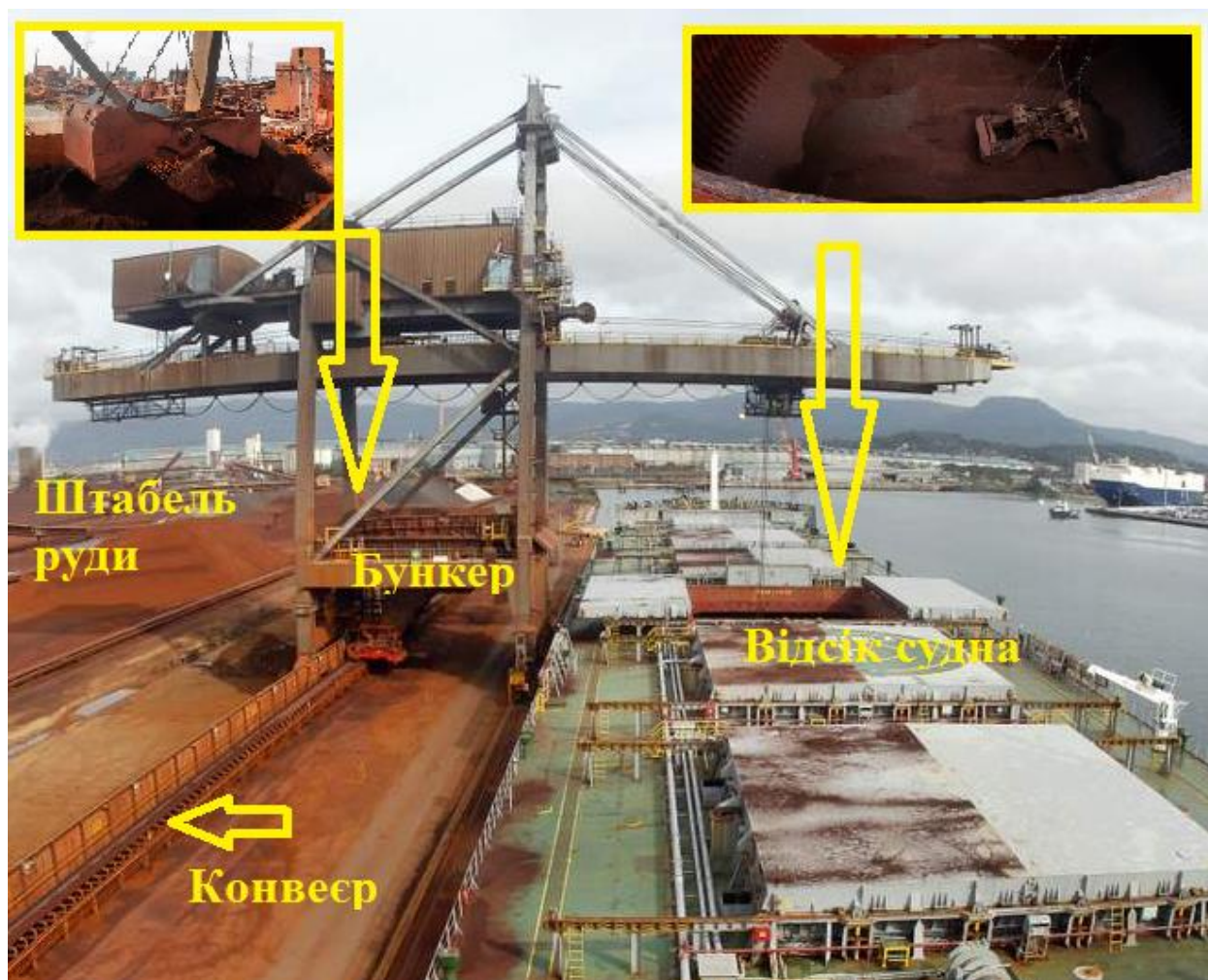
Рисунок 1.17 – Процес розвантаження судна з рудою
