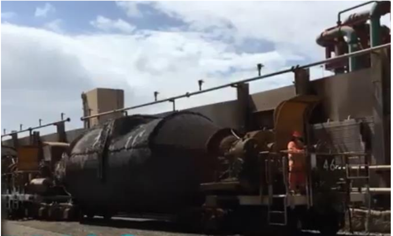
Рисунок 1.5 – Доставка рідкого чавуну від доменних печей до конвертерного виробництва
