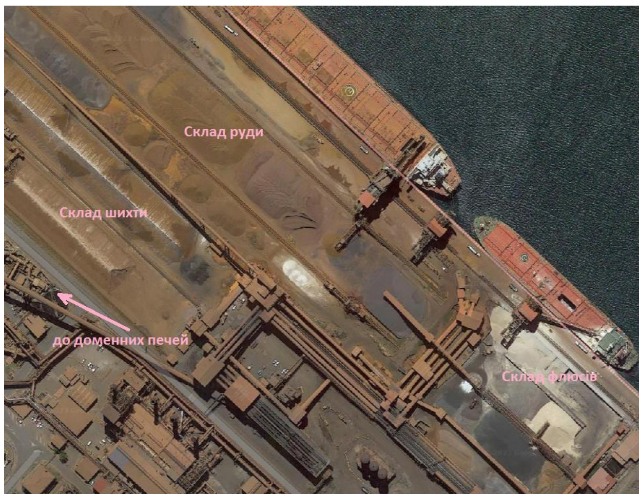
Рисунок 1.3 - Процес вивантаження руди та флюсів на склади підприємства
