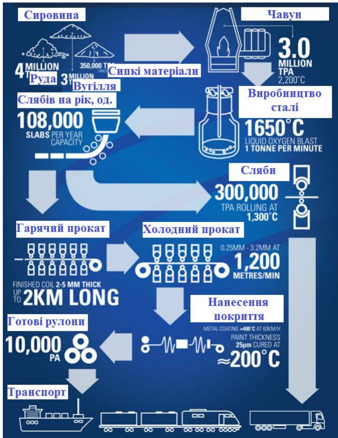
Рисунок 1.1 – Схема техпроцесу заводу Port Kembla
