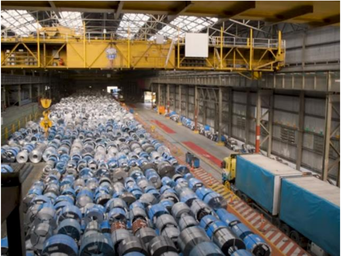
Рисунок 1.15 – Робота складу при навантаженні мостовими кранами на автотранспорт
