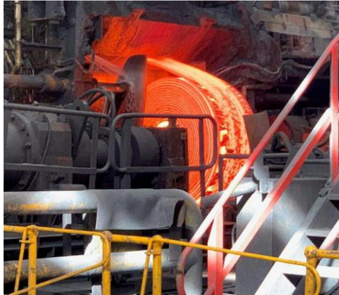
Рисунок 1.8 – Виготовлення гарячекатаного металопрокату на заводі в порту Кембла
