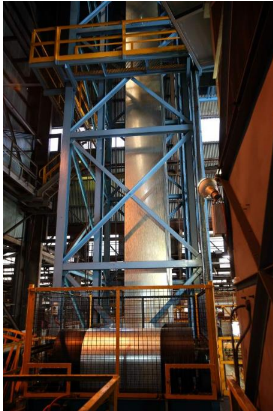
Рисунок 1.10 – Нанесення цинкового покриття на металопродукт
