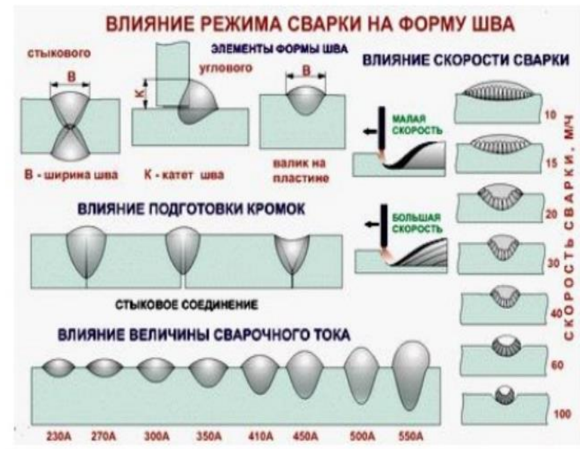
Рисунок 2.14 – Вплив режиму зварювання на форму шва
