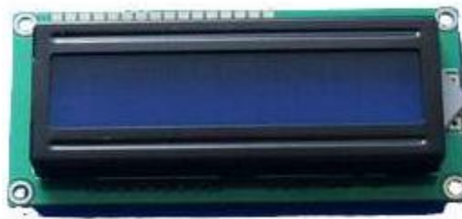
Рисунок 2.4 – Рідинно-кристалічний індикатор на чіпі HD44780
