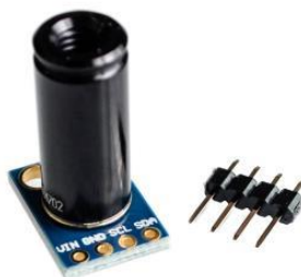
Рисунок 2.2 – Інфрачервоний датчик температури MLX90614ESF-DCI
