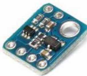
Рисунок 2.5 – Лазерний датчик GY-530 на VL53L0X
