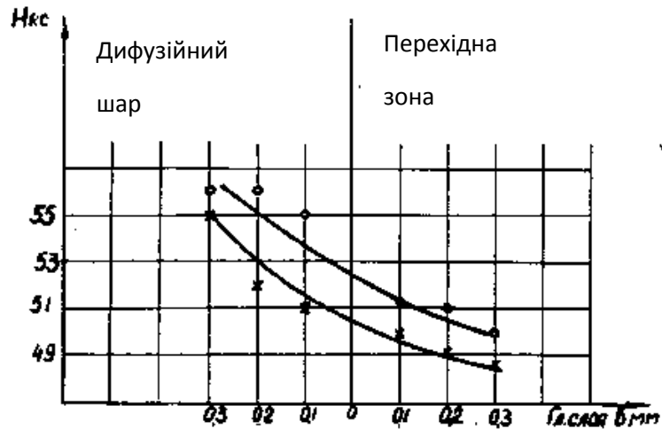
Рисунок 1.13 – Твердість перехідної зони нітроцементованого та цементованого шарів. (Нітроцементация з безпосереднім гарту, обробка холодом -60^{\circ}C , відпуск 230^{\circ}C ; Цементация, відпал, гарт, обробка холодом -60^{\circ}C , відпуск 230^{\circ}C )
