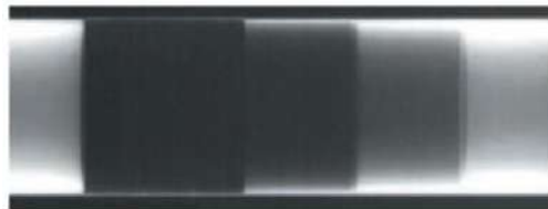
Рисунок 5.11– Рентгенограма труби \varnothing 32 мм з проточками [14]
