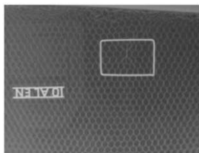
Рисунок 5.6– Цифрове зображення фрагмента стільникової конструкції закрилка літака з локалізацією дефектної ділянки для докладного дослідження за допомогою детектора S10811-11 [10]
