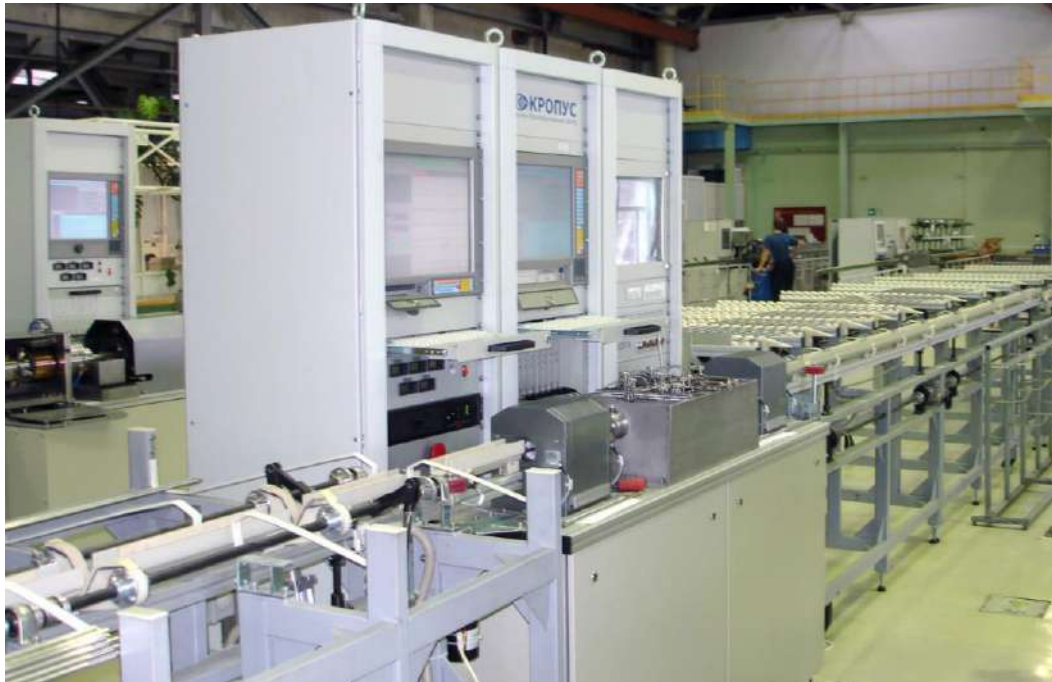
Рисунок 4.2 – Установка контролю УСКТ-8 з обертально-поступальною подачею виробів через імерсійну ванну [9]
