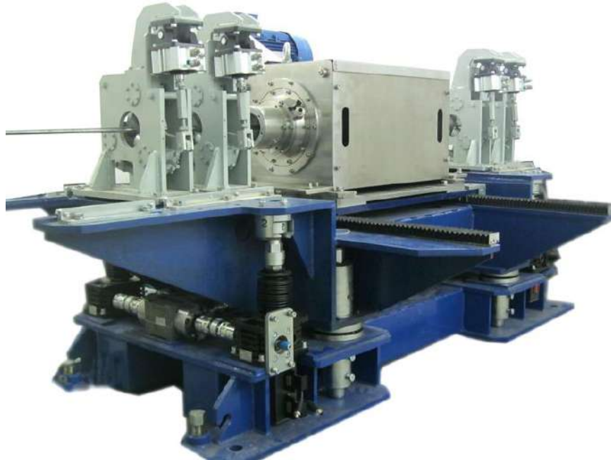
Рисунок 4.1 – Установка ротаційного типу УКВ-90, що забезпечує обертання ротора навколо труби зі швидкістю 3000 об/хв [9]
