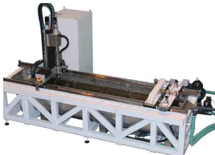
Рисунок 4.4 – Установка АСНК-ВАЛ для контролю заготовок валів авіаційних двигунів [9]
