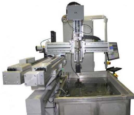
Рисунок 4.6 – Установка контролю кілець АУКП-250 [9]
