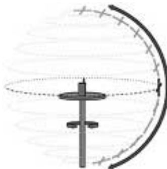
Рисунок. 1.3 – Ілюстрація методу конічної секції для вимірювання 3-D діаграми спрямованості антени
