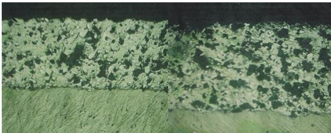
Рисунок 4.2 - Мікроструктура плазмового покриття ПКХТН-30
