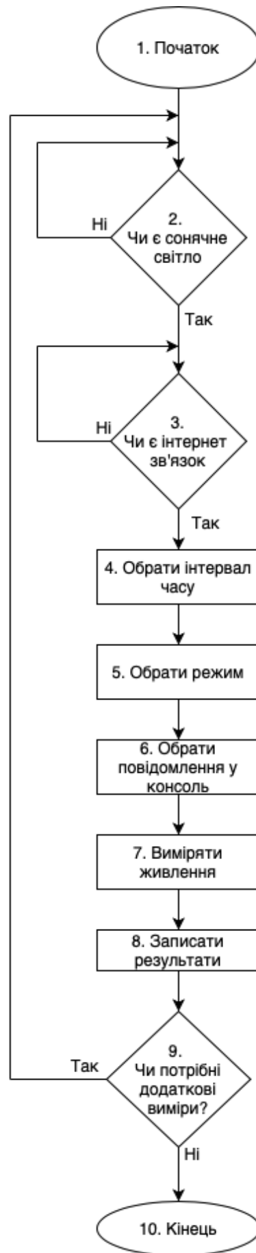
Рисунок 3.2 – Алгоритм роботи системи з сонячною панеллю
