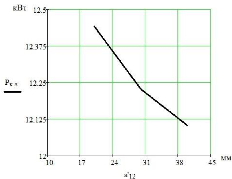
Рисунок 3.9 – Зміна втрат короткого замикання ( P_{к.з} ) зі зміною ізоляційного зазору між обмотками ВН і НН ( a'_{12} )
