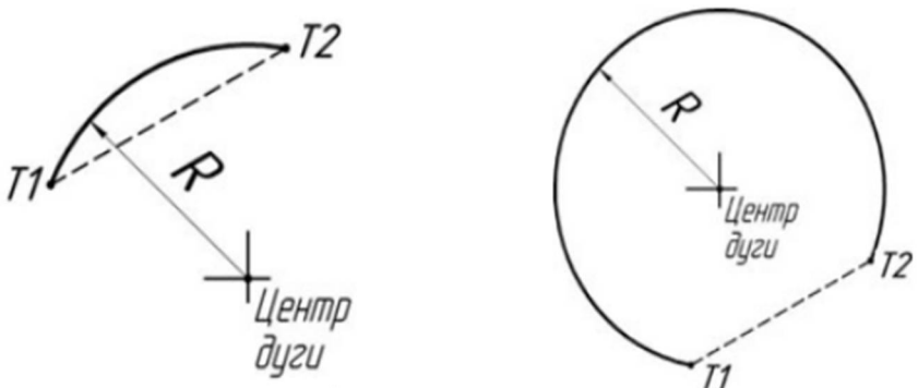
Рис 8.1- Спосіб вказування дуг з використанням радіуса R
