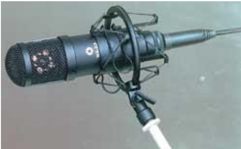
Рисунок 2.Б.2 – Мікрофон МК-369 зі спеціальним амортизувальним
