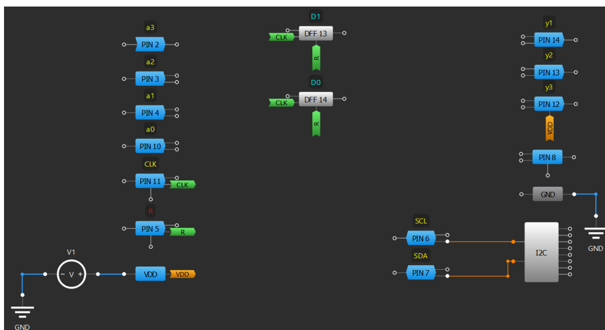
Рисунок 3.19 – Розмітка пінів, розміщення та підключення тригерів
