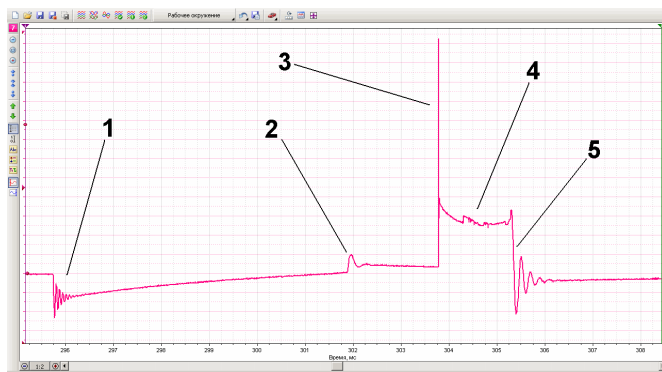
Рисунок 4.14 – Осцилограма високовольтної напруги вторинного ланцюга системи запалювання в окремо взятому циліндрі
