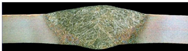
Рис. 2. Сварной шов изделия из двухфазной стали
