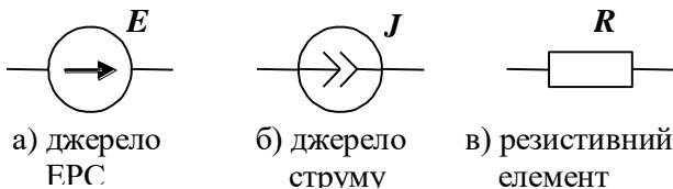
Рисунок 2.1 – Ідеальні елементи схем заміщення
