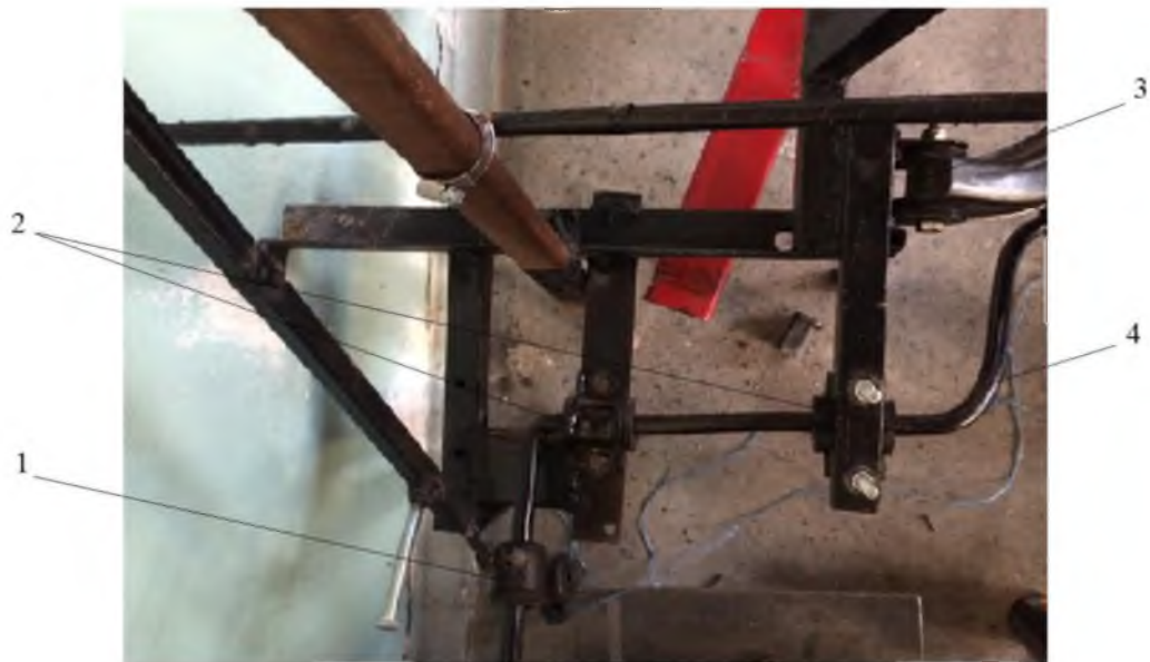
1- сайлентблок стабілізатора; 2-кронштейни стабілізатора з втулками; 3- сайлентблок важіля; 4-стабілізатор
