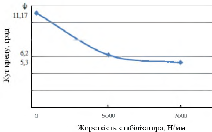
Рисунок 3.2 – Залежність кута крену підресорених мас від жорсткості стабілізатора
