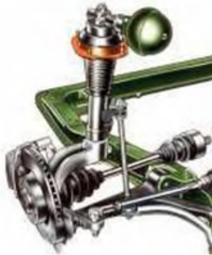
Рисунок 2.6 - Передня гідропневматичне підвіска автомобіля Citroen C5, інтегрована з підвіскою Макферсон
