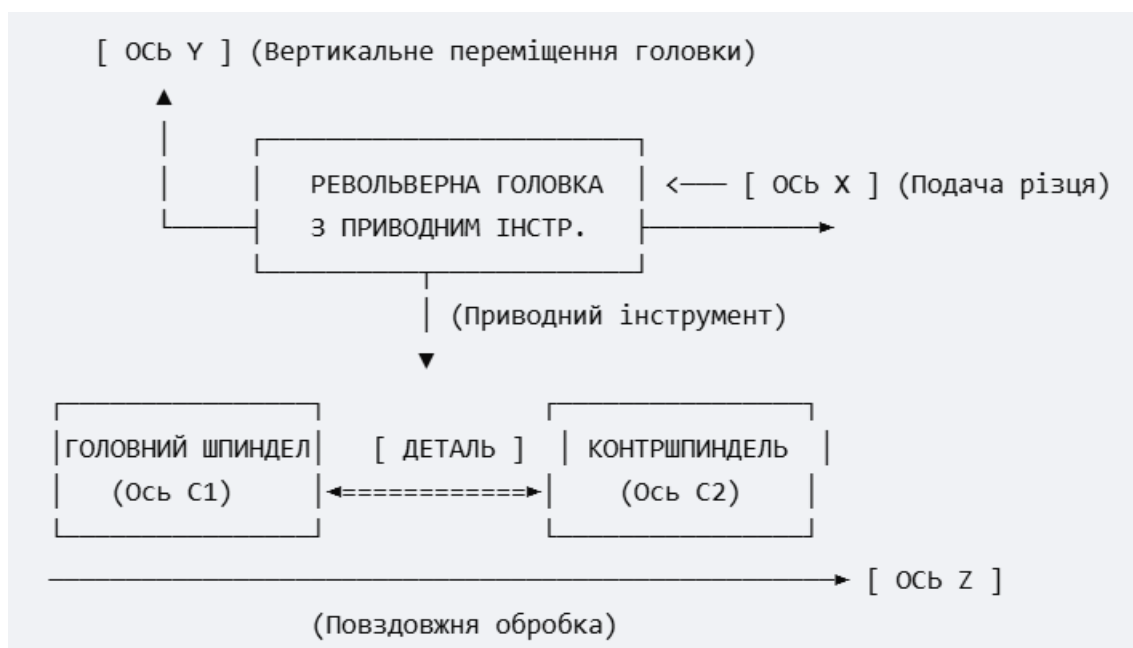
Рисунок 1.3 – Компонувальна схема токарно-фрезерного центру
