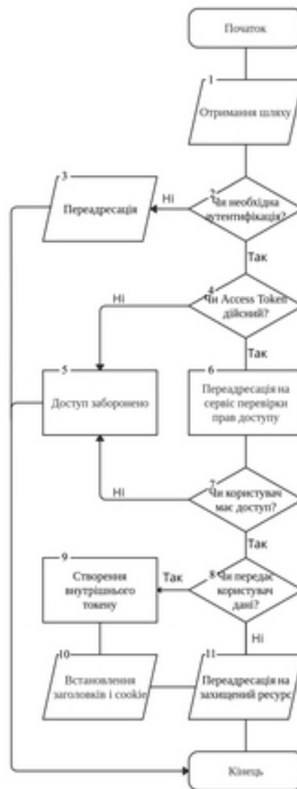
Рисунок 2.7 — Алгоритм роботи API-шлюзу
