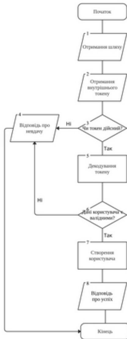
Рисунок 2.8 — Алгоритм реєстрації користувача
