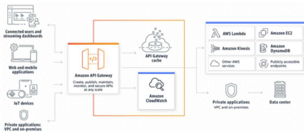
Рисунок 2.6 — Архітектура API-шлюзу Amazon [16]
