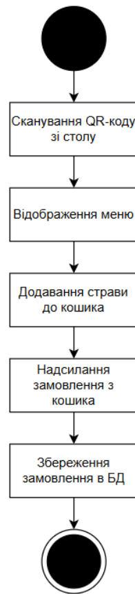
Рисунок 1.1 – Схема взаємодії клієнта та системи QR-замовлень [1]
