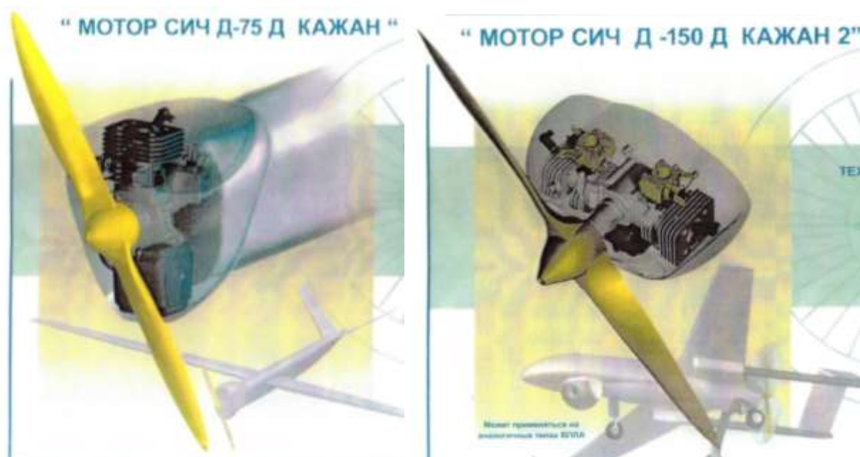
Рисунок 4.1 – Зовнішній вигляд двигунів внутрішнього згоряння в конструкції безпілотних літальних апаратів (БПЛА)
