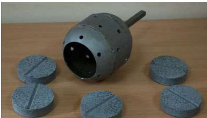
Рисунок 3.1 – Зовнішній вигляд пристосування «дзвоник» та таблетизованого РМК
