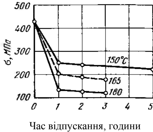
Рисунок 1.3 - Вплив відпуску на залишкові напруження ( \sigma ) у поверхневому шарі сталі X. (гартування з 850°C у маслі) [9].
