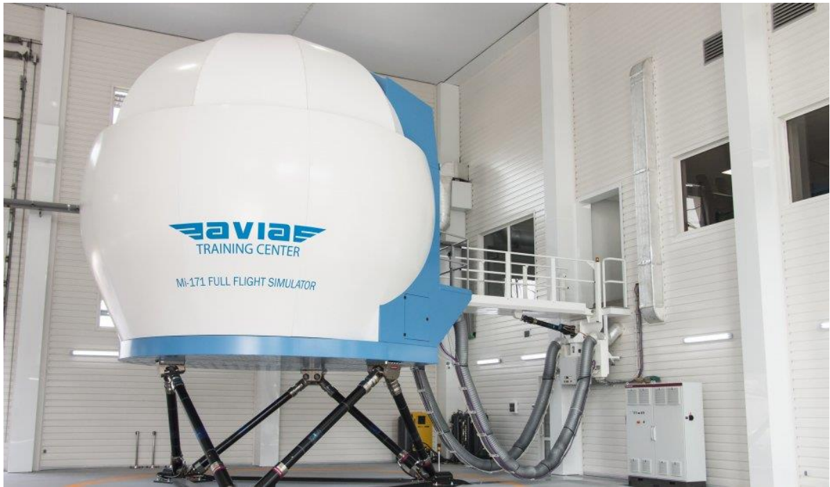
Рисунок 1.8 – Тренувальна капсула детально імітуюча реальну кабінку Ми -171
