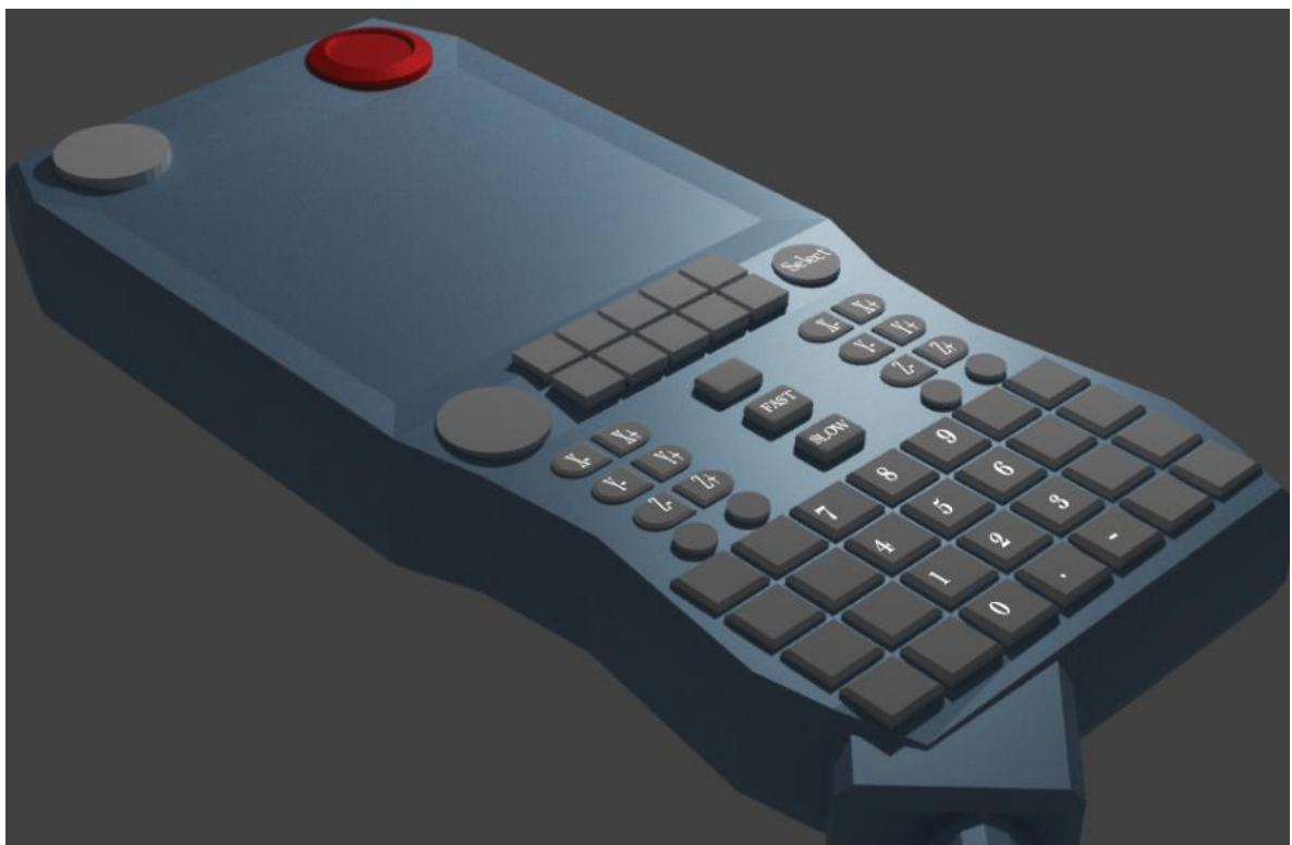
Рисунок 3.2– Вигляд пульта контролю змодельованого для віртуальної реальності
