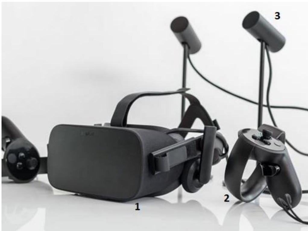
Рисунок 4.1– Комплект Oculus Rift. (1-головна гарнітура Oculus Rift, 2-маніпулятори Oculus Touch, 3–сенсор Oculus Rift CV1)
