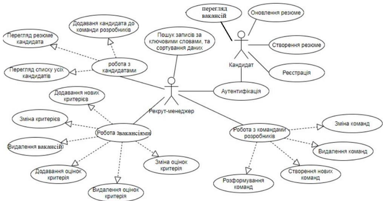
Рисунок 3.1 – Діаграма варіантів використання системи (Use Case Diagram)
