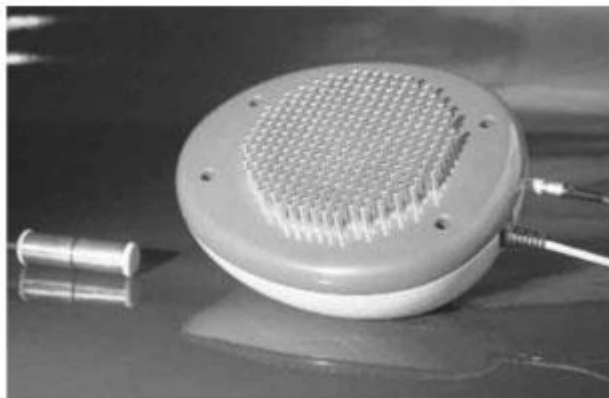
Рис. 5.2 – Матриця електродів електроімпедансного комп'ютерного мамографа
