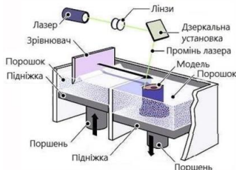
Рисунок 1.4 - Схема установки для SLM
