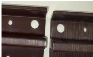
Рисунок 1.13 - Деталь до галтування (а) та після нього (б)
