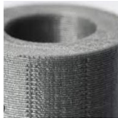
Рисунок 1.7 – Шари надрукованої деталі FDM методом
