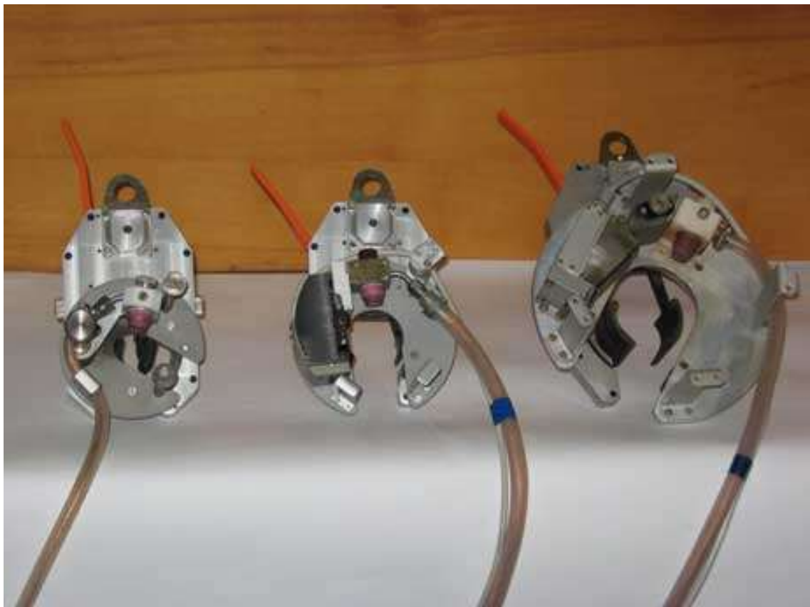
Рисунок 3.4 – Головки зварювальні відкритого типу (АДЦ 627.03.00.000, АДЦ 625.03.00.000, АДЦ 626.03.00.000)
