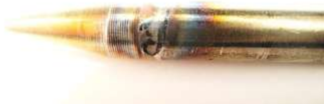
Рисунок 1.2 – Фото зварного з'єднання оболонки з конусом
