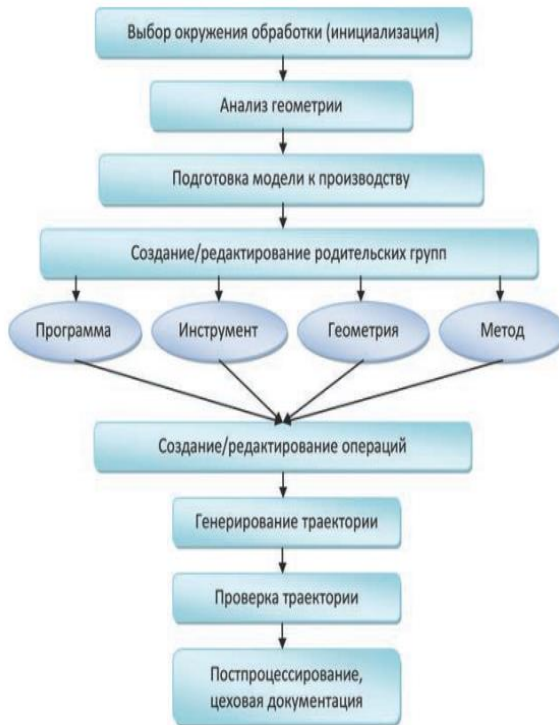
Рисунок 1.2 – Этапы разработки керуючої програми в NX CAM
