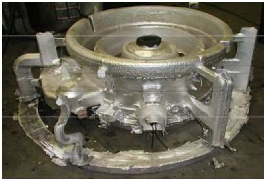
Рисунок 3.11 – Виливка «корпус паливного насоса», виготовлена з поліпшеного магнієвого сплаву МЛ5 с гафнієм, х0,4
