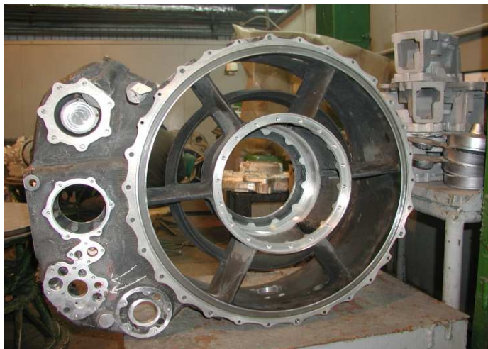
Рисунок 3.1 – Авіаційна виливка зі сплаву МЛ5: корпус паливного насоса
