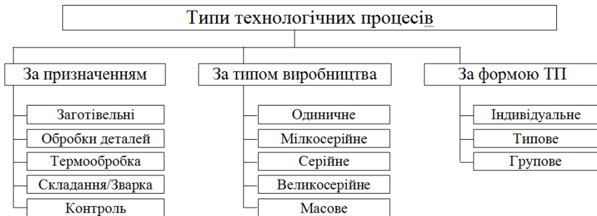
Рис. 9.1 – Класифікація технологічних процесів в машинобудуванні
