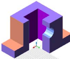
Рисунок 5 – Деталь з вирізом 1 / 4 частини
