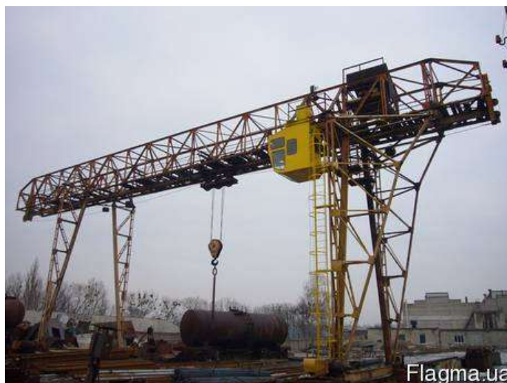
Рисунок 1.3.23 - Козловий кран ферма однобалочний двоконсольний
