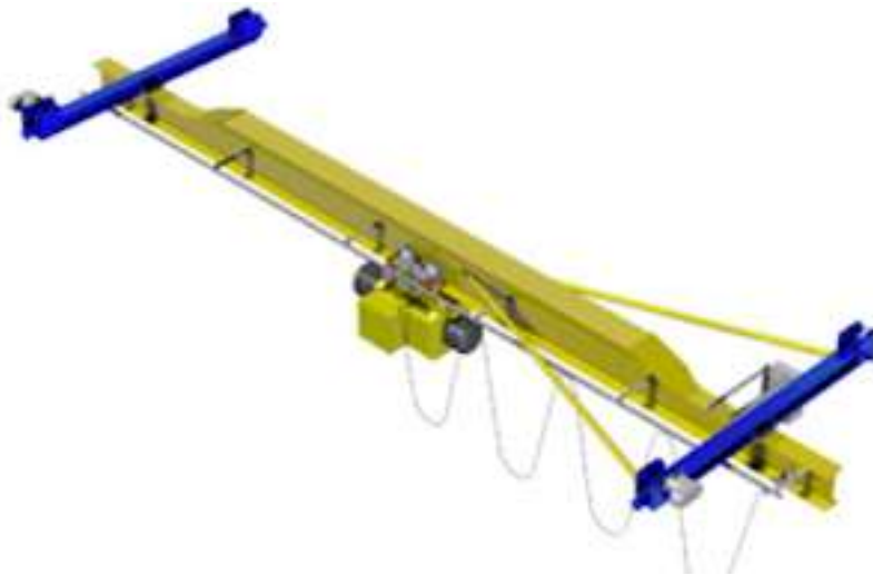
Рисунок 1.2.6 - Кран однобалочний з коробчатим посиленням
