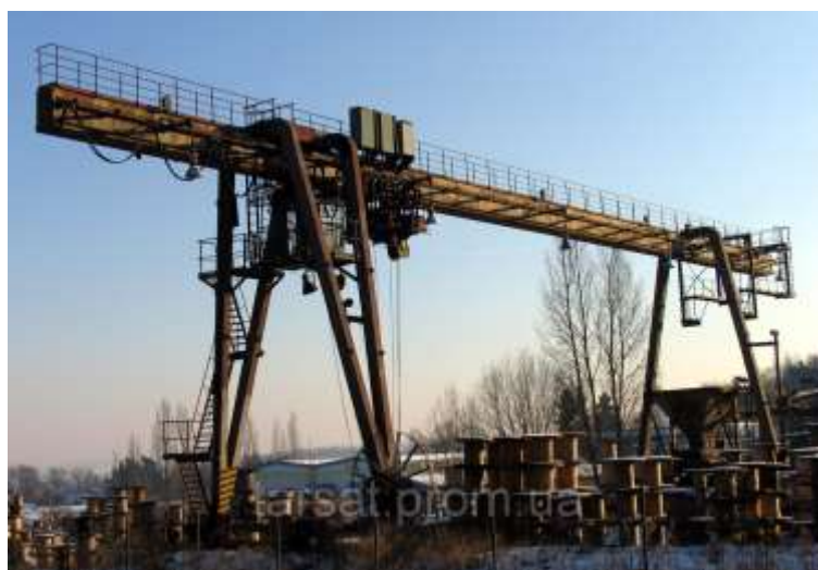
Рисунок 1.3.24 - Козловий кран однобалочний коробчата балка двоконсольний
