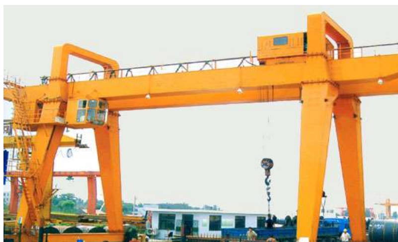
Рисунок 1.3.27 - Козловий кран двоблочний двоконсольний коробчатий проліт
