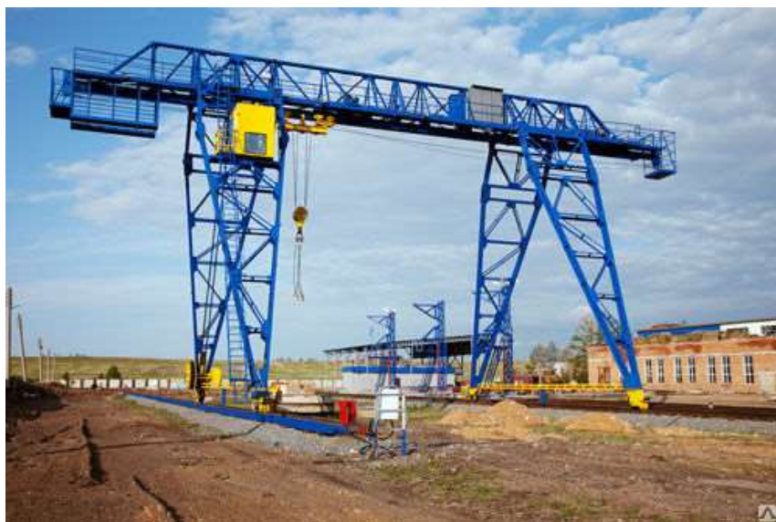
Рисунок 1.3.26 - Козловий кран ферма двоконсольний
