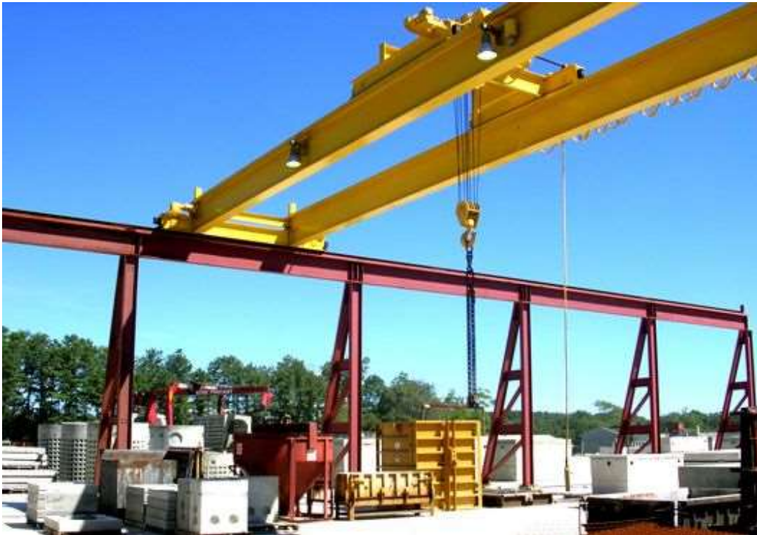
Рисунок 1.3.2 - Мостовий кран опорний двотавр двухбалочний
