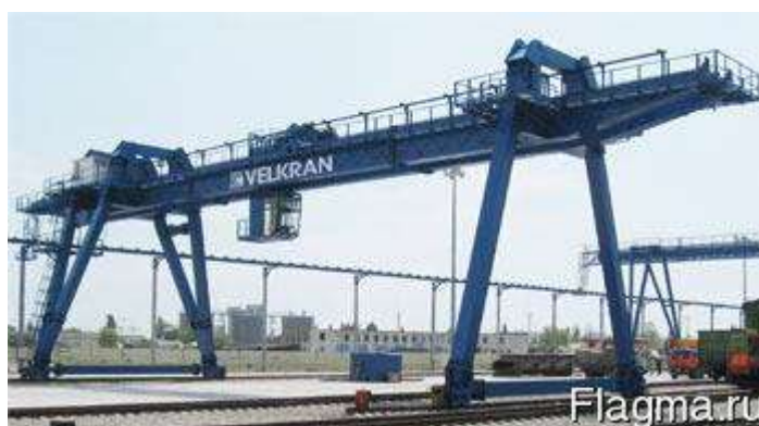
Рисунок 1.3.25 - Козловий кран однобалочний коробчата балка двоконсольний
