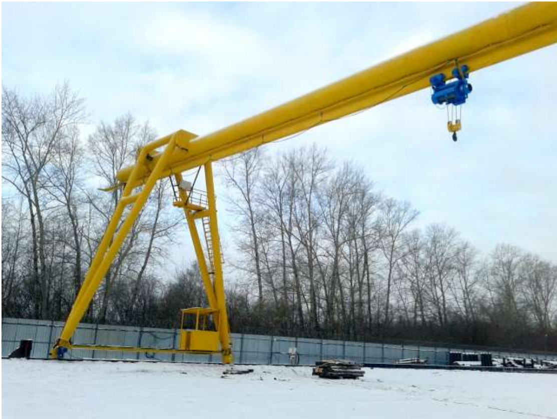
Рисунок 1.2.9 – Козловий кран мост двутавр підсилений трубою
