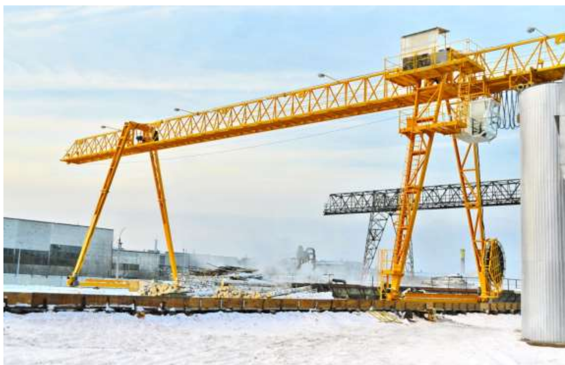
Рисунок 1.2.8 – Козловий кран мост ферма
