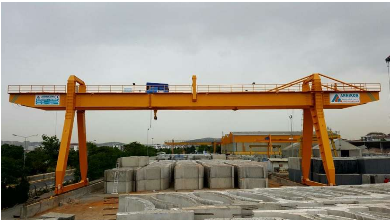
Рисунок 1.2.7 – Козловий кран мост короб
