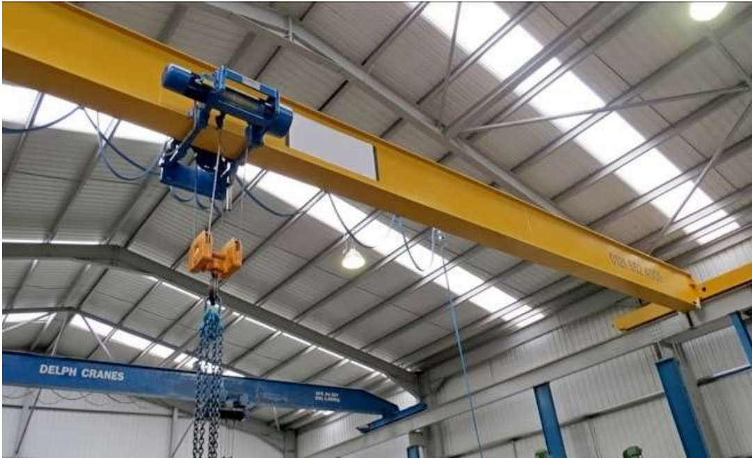
Рисунок 1.2.3 - Кран однобалочний з сварного двотавра
