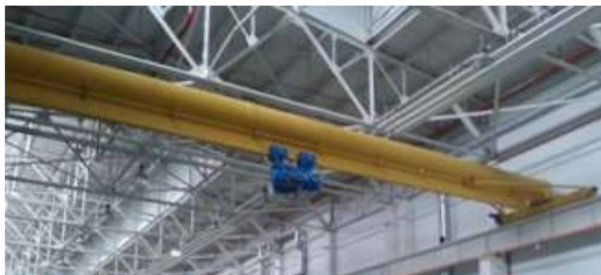
Рисунок 1.2.4 - Кран однобалочний посилений трубою
