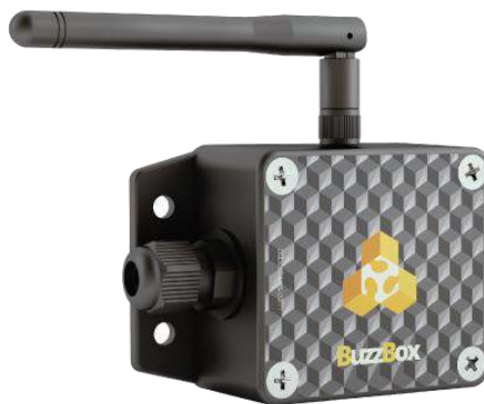
Рисунок 1.5 – Система віддаленого моніторингу стану вулика "BuzzBox"
