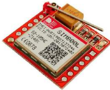
Рисунок 3.2 – Модуль GSM/GPRS SIM800L MicroSIM з антенною
