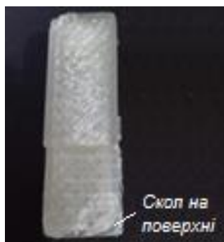
Рисунок 8. Скол, який виник при фрезеруванні зразка, створеного при висоті шару 0,5 мм
