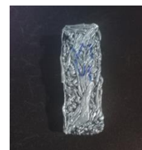
Рисунок 9. Нашарування пластика при перебільшеній екструзії
