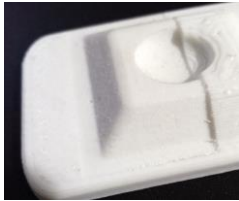
Рисунок 21. Поверхня моделі з ABS-пластику
