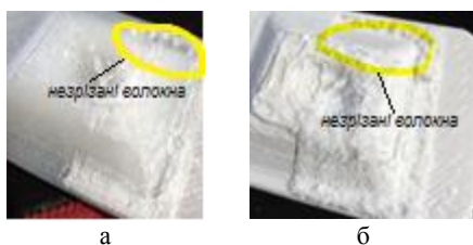
Рисунок 24. Поверхня моделі з Nylon (а) та PBT пластику (б)
