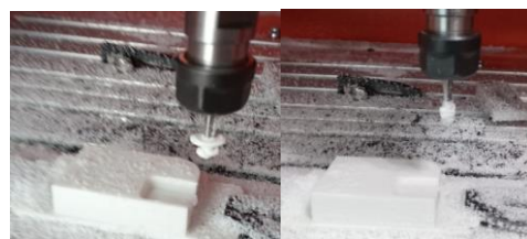
Рисунок 25 Пластик, що налип на прямозубу фрезу
