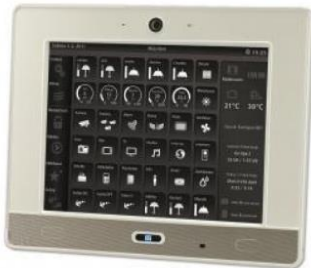
Рисунок 1.3 – Сенсорна панель iNels [21]
