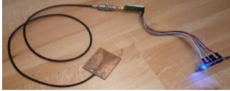
Рисунок 3 – Макет антени Вівальді на підкладці 1,5 мм з текстоліту FR4
