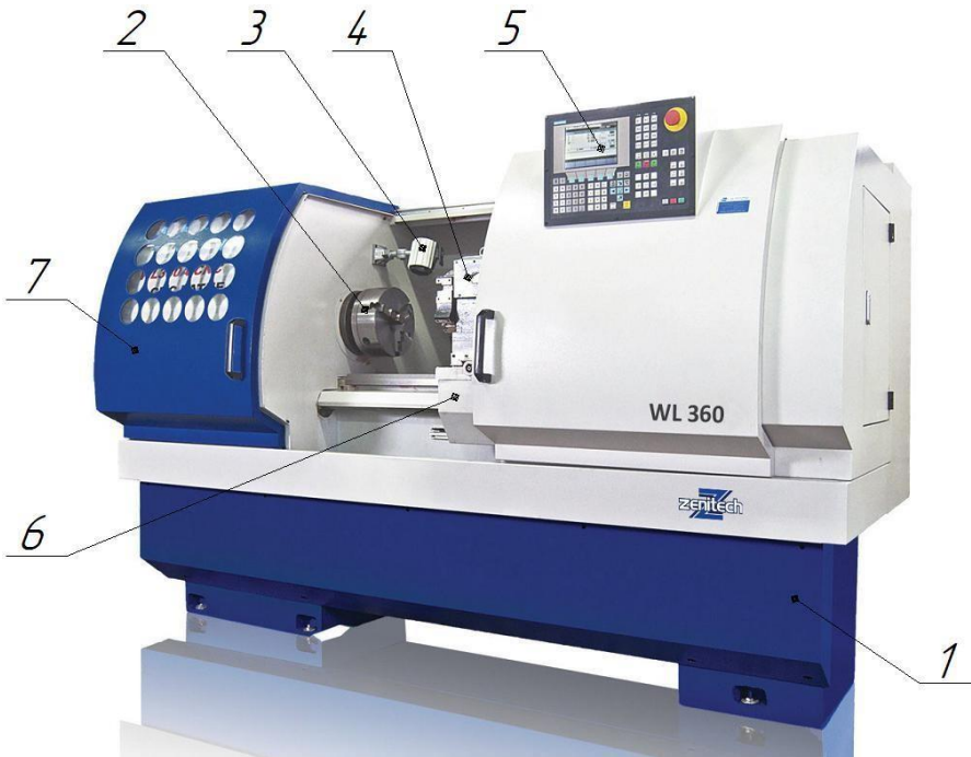
1 – станина; 2 – 3х-кулачковий патрон; 3 – лампа освітлення; 4 – різцетримач; 5 – пульт керування; 6 – супорт; 7 – захисний кожух Рисунок 5.1 – Органи керування токарного верстата Zenitech WL 320
